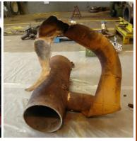
這些操作溫度的改變引起大氣中的水氣冷凝在管子外面,然後再蒸發掉。這就是眾所皆知的保溫(包覆)層下的腐蝕(Corrosion Under Insulation, CUI)的高風險狀況。如果機械完整性團隊未注意到其操作條件不斷的改變,就很容易錯過它。
