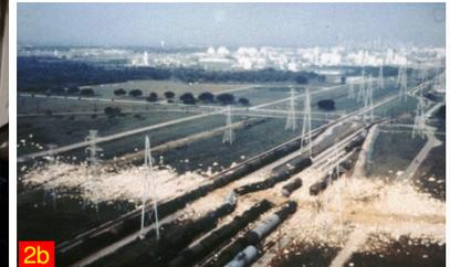
**事故2：**有人注意到裝有粗製甲基丙烯酸 (MAA) 的鐵路槽車發熱而有物質從其安全閥排放出來。該地區人員被撤離，過了不久，鐵路槽車爆炸了，毀掉槽車，並在該區造成嚴重的破壞 (圖2a和圖2b)。由於人員已經撤離，沒有人受傷。
